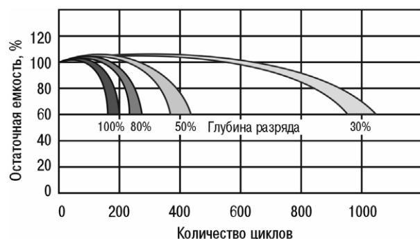
Рис. 11а. Зависимость циклического ресурса от глубины разряда для серий BC, HR, HRC, SHR
