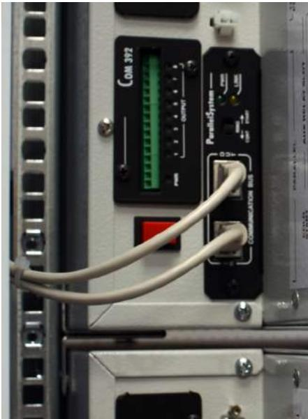
*Параллельное подключение и плата контактов программируемых реле*
